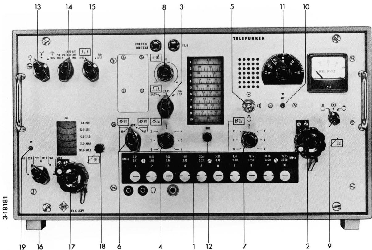
Bild 1. Anordnung der Bedienelemente auf der Frontplatte
